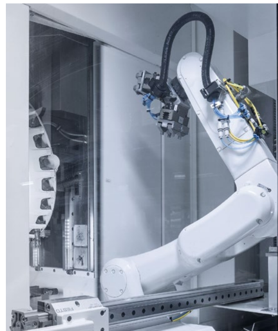
El robot de WH 3 Cell permite la manipulación de piezas de hasta 5,5 kg.
