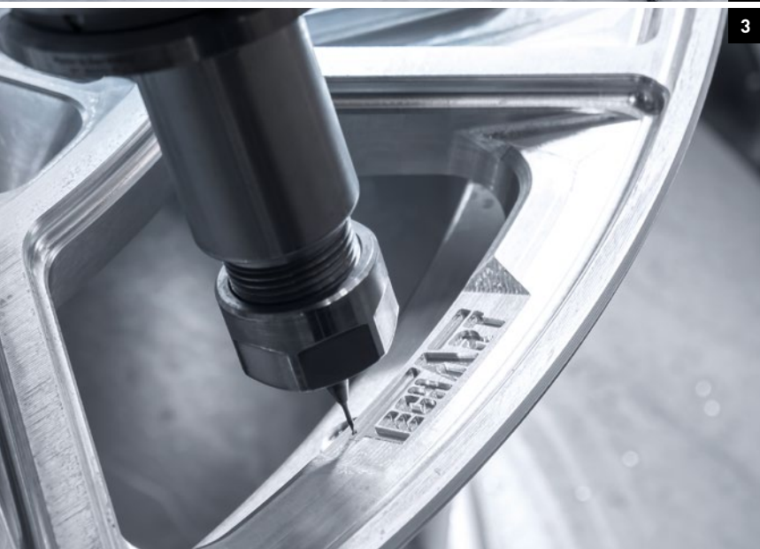
1. + 2. Como cliente de prueba de campo, ROC ha sometido a un examen exhaustivo a cinco DMU 75 monoBLOCK 2 nd Generation. En total hay operativas 14 máquinas monoBLOCK. 3. Gracias al husillo speedMASTER con 20.000 rpm y 130Nm, ROC logra en DMU 75 monoBLOCK tanto un alto volumen de arranque de viruta como estructuras sofisticadas. 4. Con la construcción de nuevas ruedas forjadas, ROC es también socio de desarrollo de fabricantes de automóviles.
