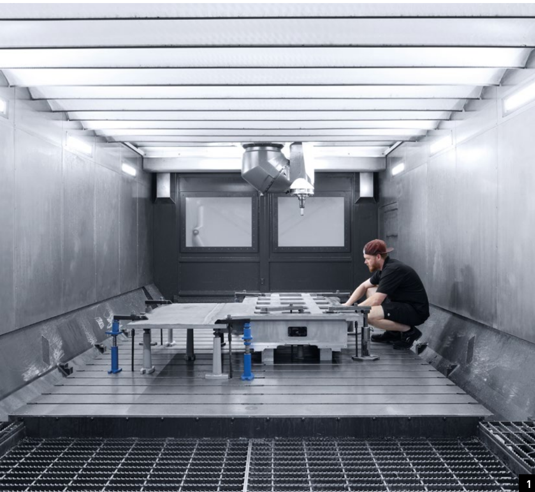
1. En la DMU 340 Gantry, Schittl produce, entre otras cosas, bancadas de máquina de alta precisión. 2.+3. Schittl ha implementado un mecanizado automatizado de 5 ejes en una CMX 70 U con PH 150. Para la producción sin operarios o con muy poco trabajo humano, el PH 150 dispone de 8 puestos de palets.
