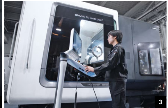
3. El centro de fresado-torneado de 5 ejes DMU 80 FD duoBLOCK puede sustituir varios centros de torneado, centros de fresado y máquinas de engranajes.
