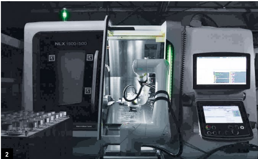
1. El centro de mecanizado NLX 1500 y MATRIS Light de DMG MORI se emplean para el mecanizado de componentes de la SATELLITE FIRE BASE. 2. El sistema MATRIS Light se hace cargo de la manipulación automática de las piezas durante la noche. Así son posibles turnos de noche sin operarios y una mayor velocidad de trabajo.
