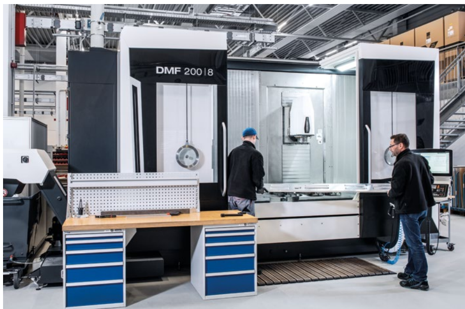
La DMF 200|8 se emplea para el mecanizado de componentes de perfil largos de alta precisión.
