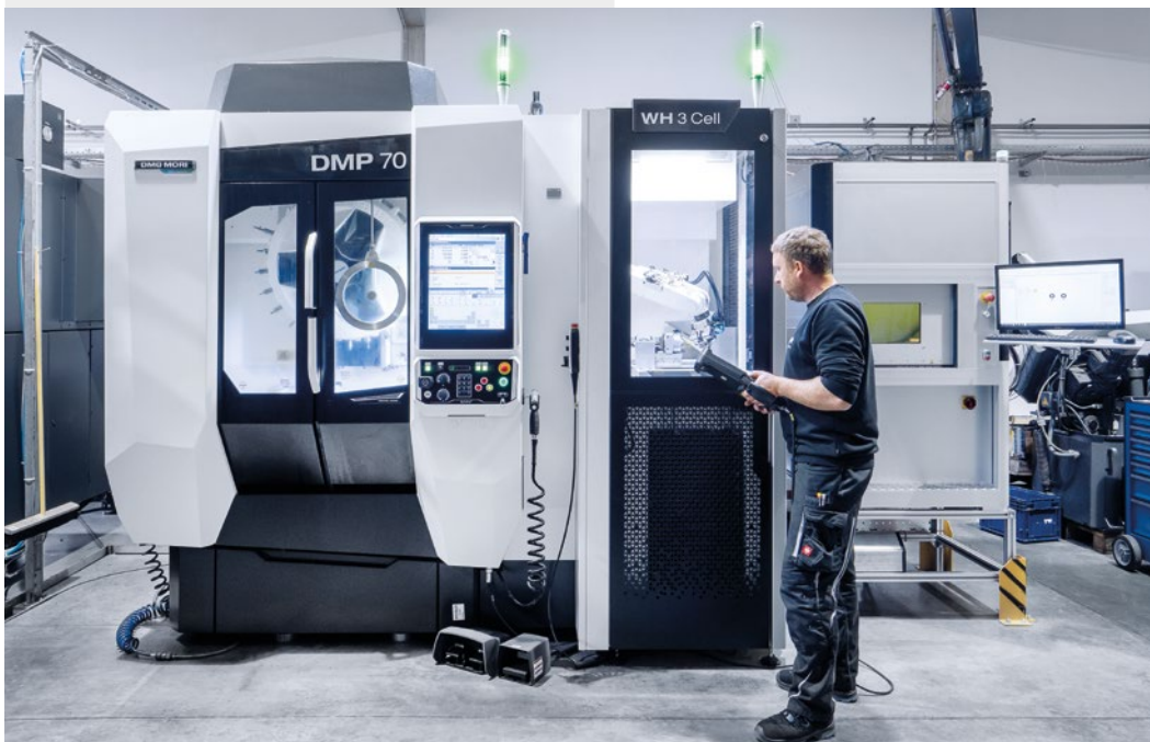
Mínimo espacio requerido: La DMP 70 y WH 3 Cell necesitan una superficie de emplazamiento inferior a 9 m 2 . Dependiendo del tamaño de las piezas, WH 3 Cell ofrece espacio para más de 1.000 piezas.
