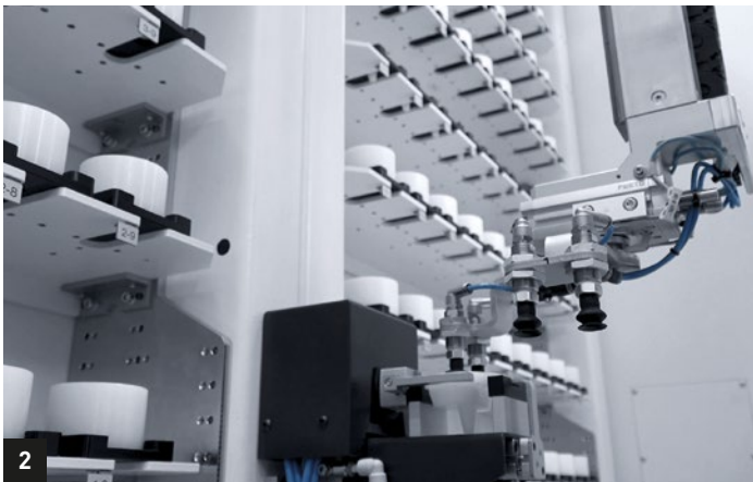
1.+2. Versión del PH 10 como manipulación de piezas para hasta 126 piezas brutas o acabadas de los componentes de tibia.
