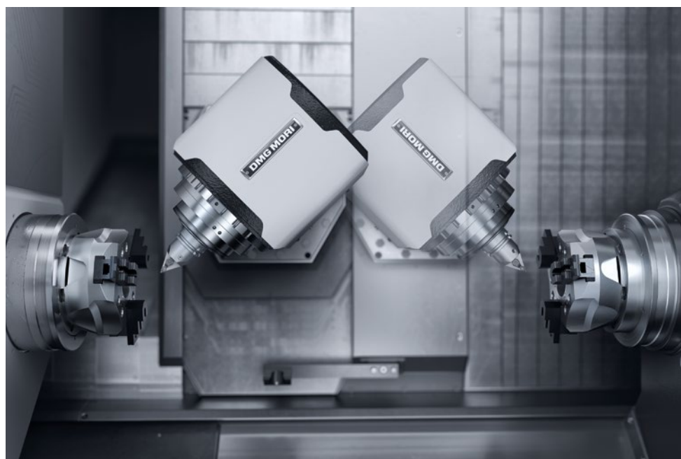
Una herramienta para husillo principal y contrahusillo // mecanizado completo de 6 lados.
