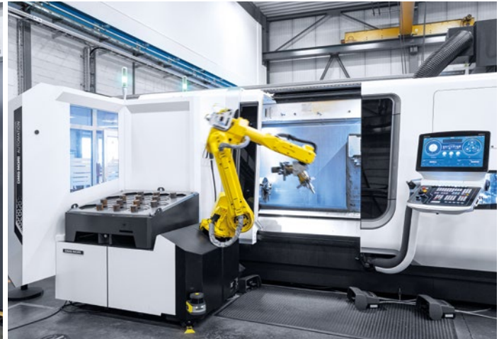
Gracias al mecanizado completo automatizado de 6 lados en la CTX beta 1250 TC, el tiempo de mecanizado de las piezas se reduce en hasta un 80% a 1,5 horas.
