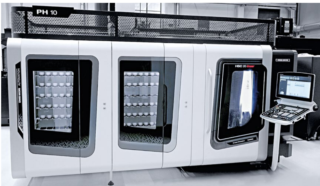
HSC 20 linear con una versión doble del PH 10 como manipulación de piezas
