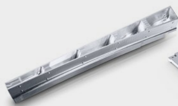
AERONÁUTICA COMPONENTE INTEGRAL Medidas: 1.750 × 200 × 300 mm Material: Aluminio Tiempo de ciclo: 18 minutos
