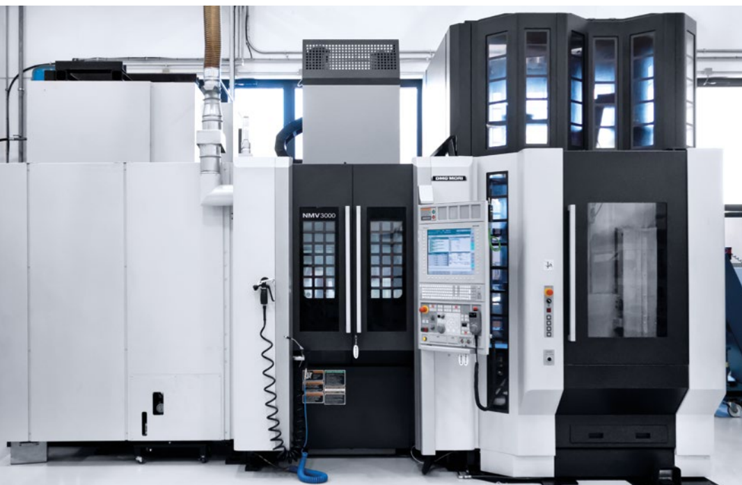
Gracias al almacén de palets AWC podemos trabajar autónomamente en la NMV 3000 DCG con 34 palets para piezas de hasta \varnothing 350 \times 300 mm/máx. 80 kg. Gracias al diseño compacto, la superficie de emplazamiento es de menos de 3,8 m 2 .
