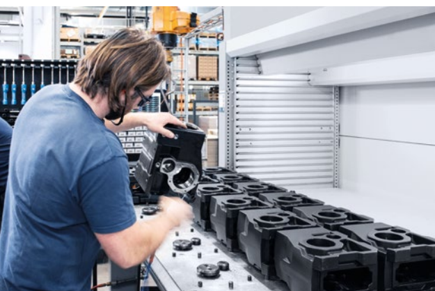
La célula de producción se carga por medio de un almacén automático de piezas pequeñas. Las piezas acabadas también se toman de aquí.
