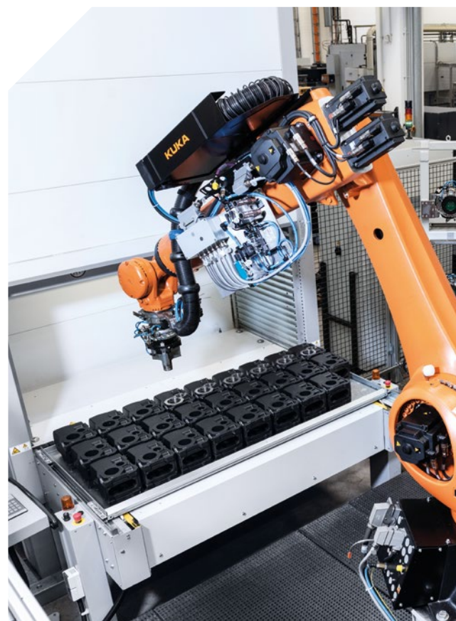
El robot toma más de 100 piezas brutas diferentes del almacén automático de piezas pequeñas para equipar con ellas los palets.
