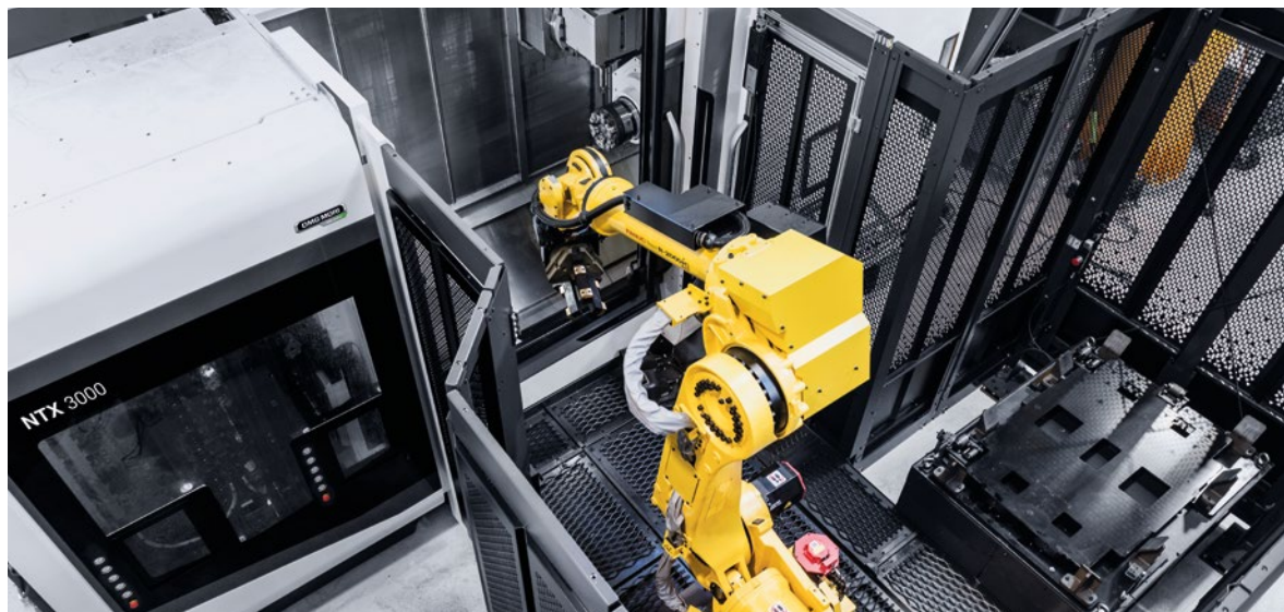
Gracias a Robo2Go y a MATRIS, las dos NTX 3000 trabajan autónomamente durante muchas horas.
