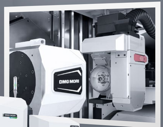
Cambio automático entre cabezal láser y husillo portafresa.
