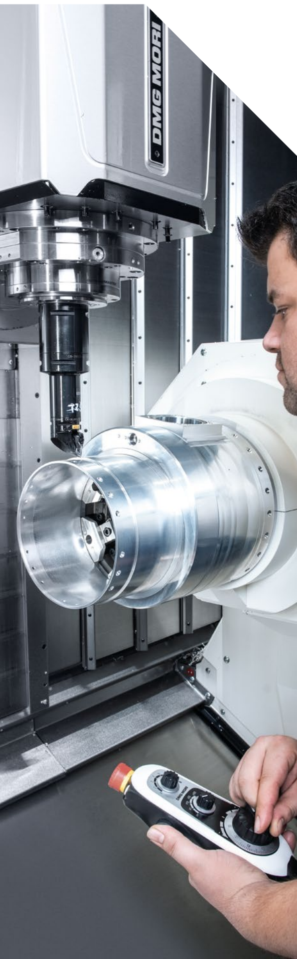
La carcasa y la tapa de los tubos de rayos X son torneados excéntricamente con ayuda de un ciclo de tecnología exclusivo de DMG MORI.
