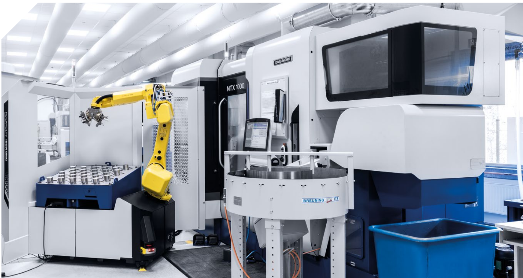
Entre las inversiones más recientes de LINK se cuentan dos NTX 1000 con Robo2Go para la producción automatizada de copas acetabulares.
