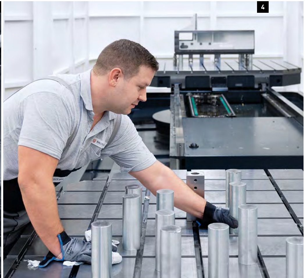
1. Thorsten Deumlich, Director de mecanizado de grandes piezas, Baltic Metalltechnik GmbH 2./3. En la DMC 340 U se mecanizan con 5 ejes los componentes de máquina complejos y de alta precisión para el Hauni Group. 4. El operario Marc Hänel prepara las piezas para el mecanizado, una mesa especial con ranuras especiales facilita el proceso de preparación.
