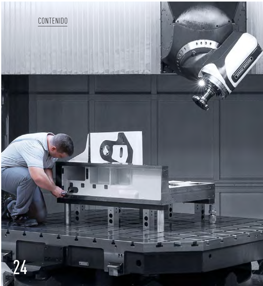
Baltic Metalltechnik: 45 máquinas DMG MORI en el mecanizado de precisión, entre ellas una DMC 340 U para piezas las grandes hasta 3 m en un rango de centésimas.
