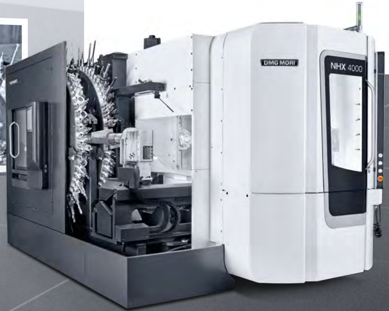
Rueda exterior con 63 posiciones de herramienta disponibles, ruedas interiores con 60 posiciones de herramienta disponibles.
