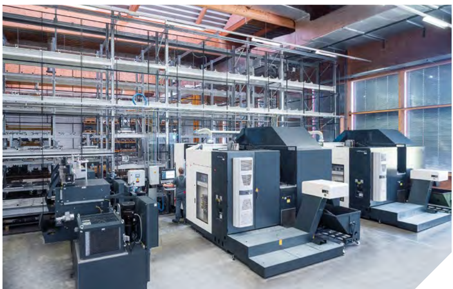
Dos DMC 60 H linear están conectadas al almacén de palets de 100 posiciones. En combinación con el cargador de herramientas de 303 posiciones se garantiza la producción autónoma durante la noche y los fines de semana.
