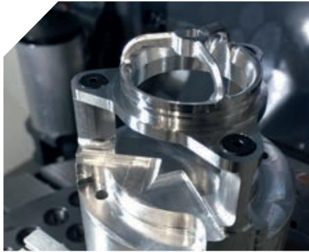
Ejemplo: Asiento de válvula de alta precisión para el coche de carreras de Andretti Autosport, fabricado en la DMU 50 - fresadora universal de 5 ejes de DMG MORI.
