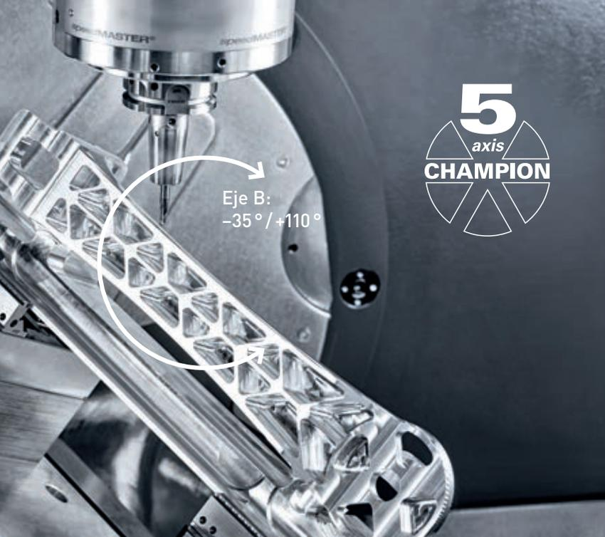
Mesa giratoria basculante para el mecanizado simultáneo de 5 ejes de piezas hasta 300 kg.
