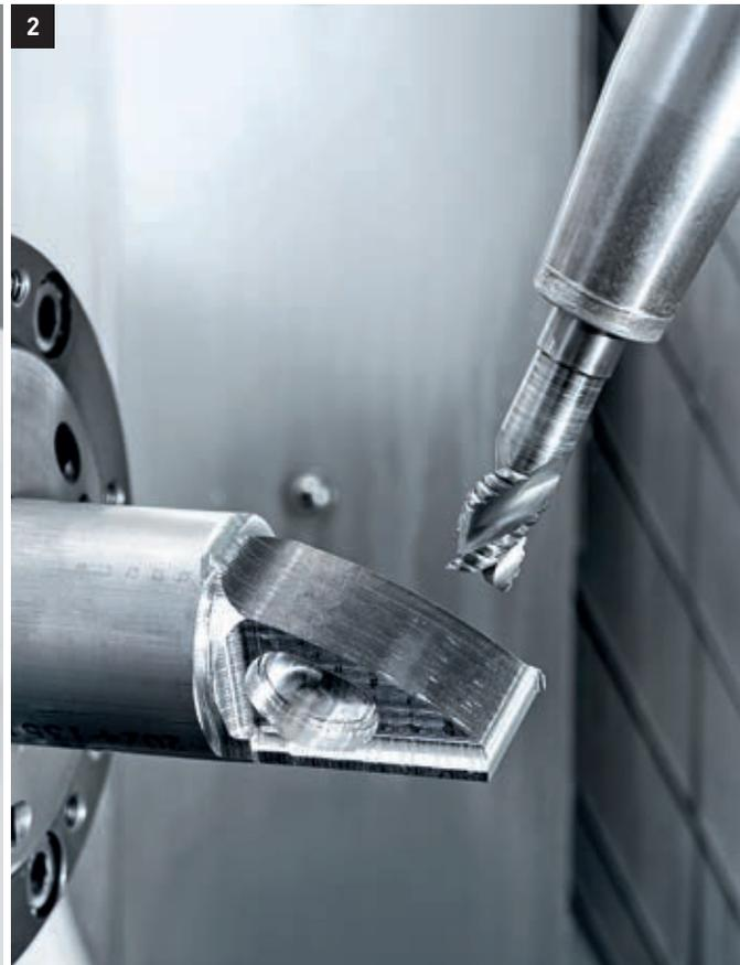
1.-3. La estabilidad y el rendimiento de arranque de viruta de las máquinas de DMG MORI permiten el mecanizado de alta precisión de los complejos componentes de las prótesis de aluminio, acero o titanio. 4. Larus Gunnsteinsson, diseñador de productos
