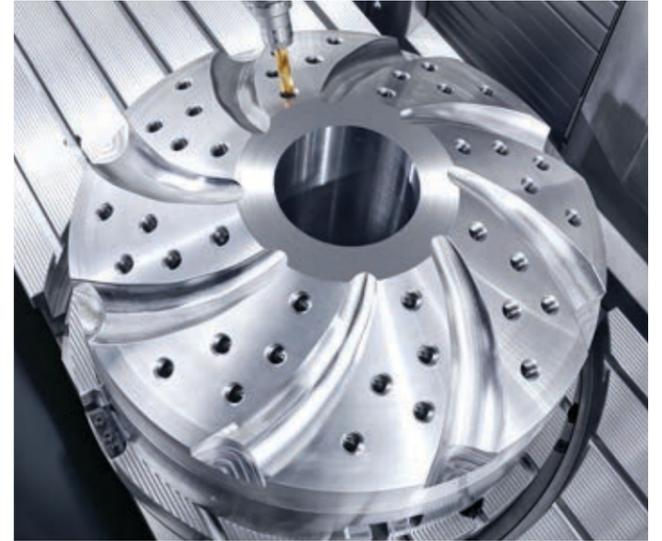
Mesa rotativa CN integrada para el mecanizado de fresado / torneado en 5 ejes.
