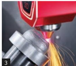
3 Soldadura de recargue por láser y fresado combinado en la LASERTEC 65 3D (posible cambio flexible).
