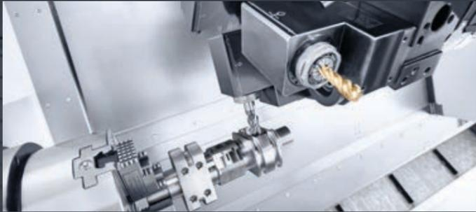
OPCIÓN // Eje Y con un recorrido de 60 mm, mecanizado de fresado en tornos
