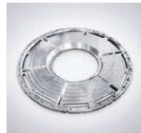
Piezas con diámetros de hasta 630 mm, p.ej. para equipos de IRM o TC, se mecanizan en la NHX 4000.
