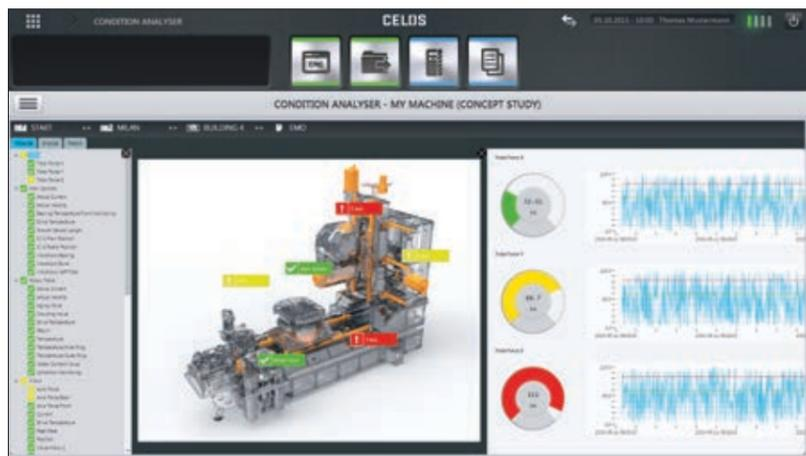
> Medición, visualización y análisis de fuerza, vibración, temperatura y lubricación.
