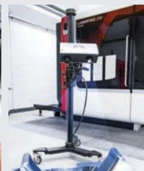
Medición de la geometría de la herramienta mediante escáner 3D.
