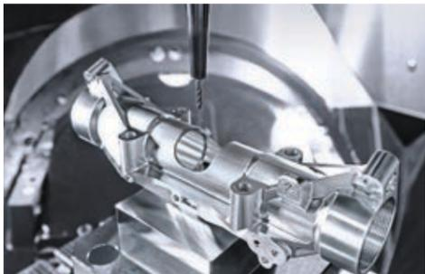
Mecanizado en 5 ejes en una DMU 60 eVo.
