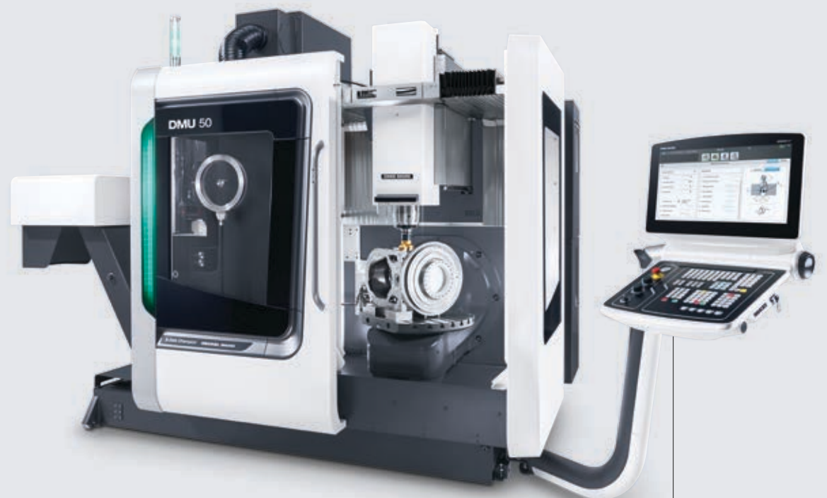
Campo de oscilación de la mesa rotativa basculante: -5° y máx. +110°.
