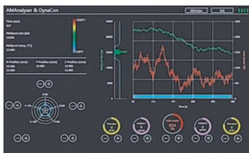
Control adaptativo de procesos Ajuste automático de la potencia del láser.
