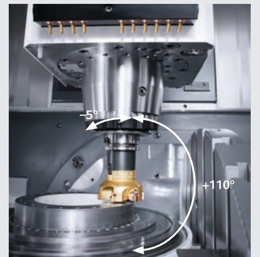
Campo de oscilación de la mesa rotativa basculante: -5° y máx. +110°.
