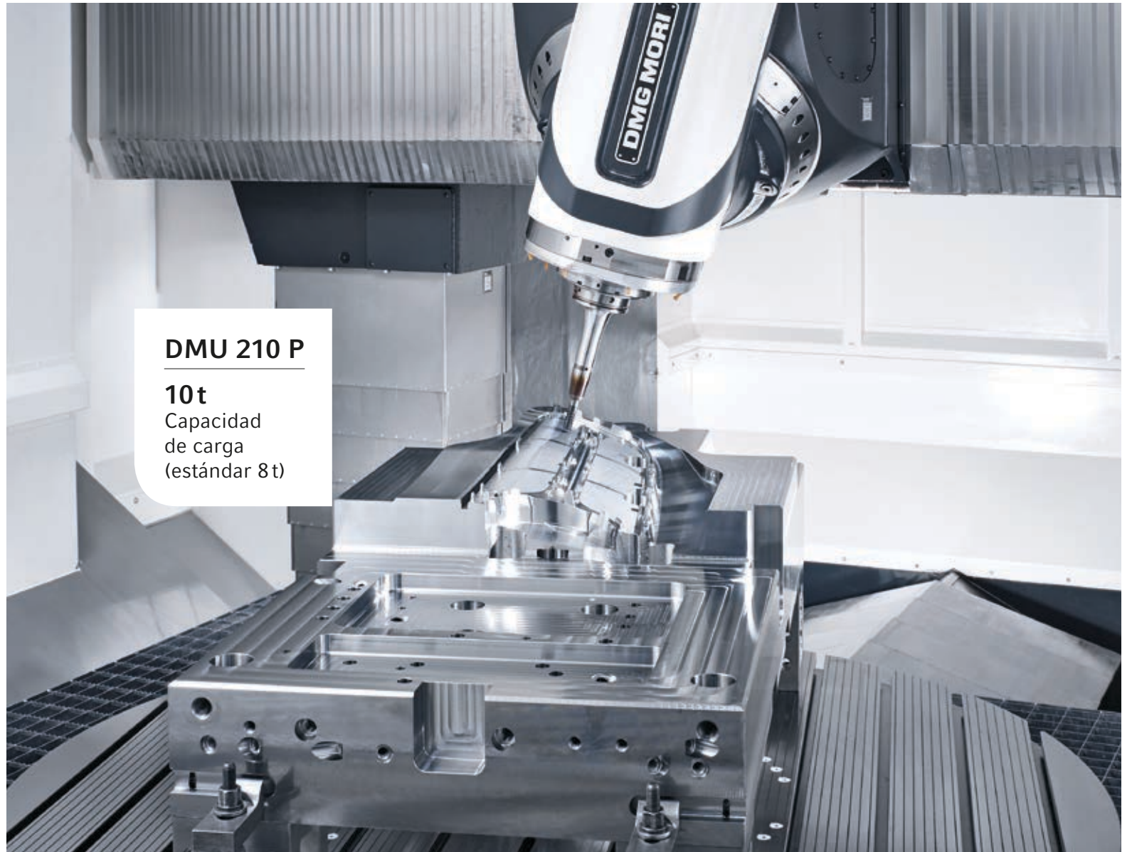
DMU 210 P y gearMILL® Software para el complejo mecanizado de una espiga AGMA Q11.
