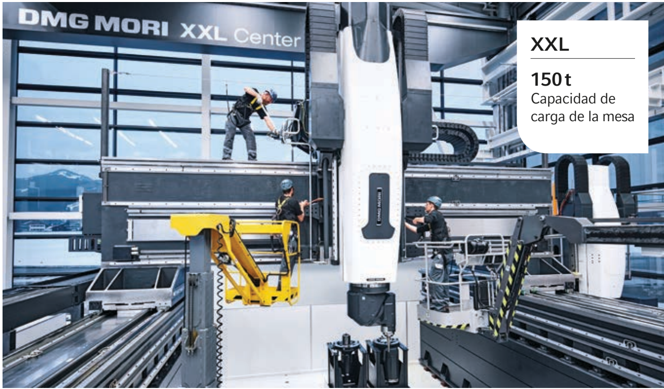
Arriba: DMU 600 G linear en construcción en el centro XXL de DECKEL MAHO en Pfronten, la fabricación de máquinas grandes más moderna del mundo. Abajo: Nivel de precisión constante gracias a la temperatura estable de la estructura de la máquina.
