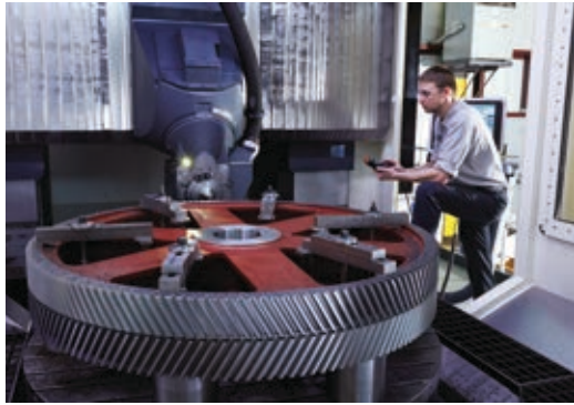
DMU 210 P y gearMILL® Software para el complejo mecanizado de una espiga AGMA Q11.
