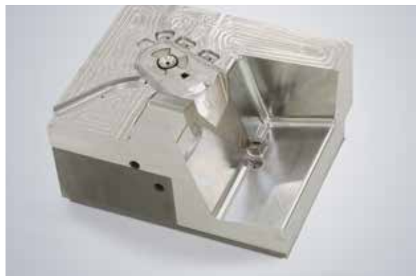
RC 50 Die-Var cavidad insertada mostrando que tan definido y detallado es el acabado alcanzado en una máquina de tecnología HSC.
