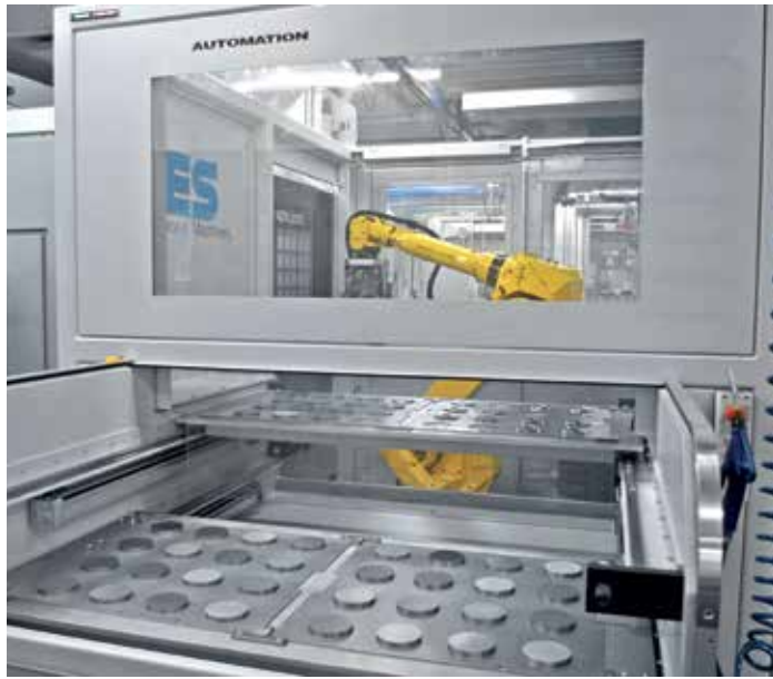
El almacén de piezas integrado para piezas de máx. 300 kg por cajón garantiza que la facilitación de las piezas brutas sea segura y eficiente.
