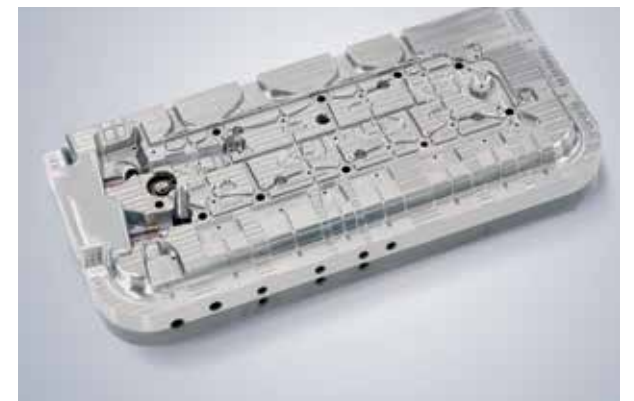
Complejo molde de block de cavidad maquinado en un nivel de requerimiento significativamente menos pulido que en el pasado.
