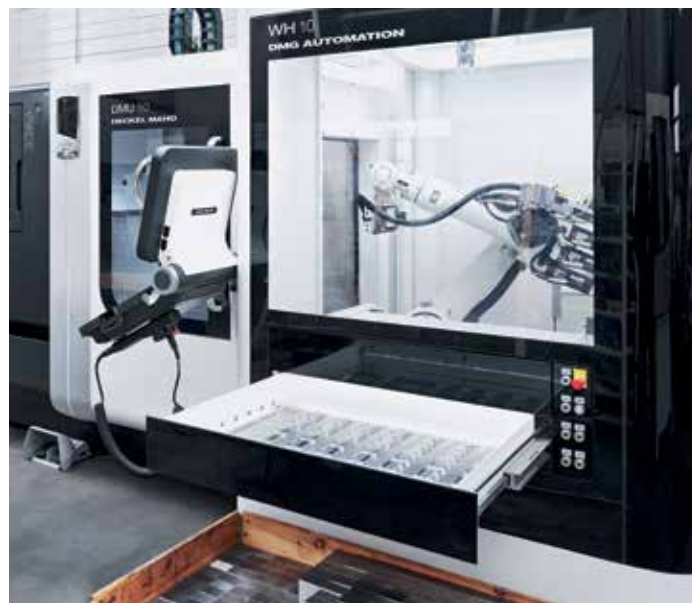
Gracias a la DMU 50 con sistema de carga WH10 la empresa Gaiser-Mechanik puede entregar sus productos más rápido.
