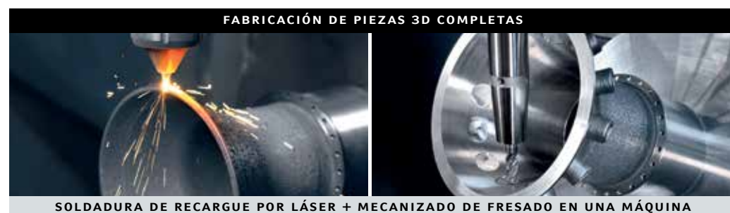
FABRICACIÓN DE PIEZAS 3D COMPLETAS SOLDADURA DE RECARGUE POR LÁSER + MECANIZADO DE FRESADO EN UNA MÁQUINA
