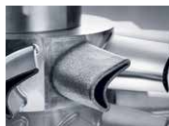
Soldadura de recarga por láser y fresado de palas de turbina
