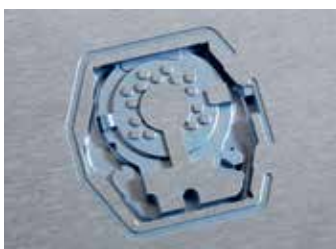
Erosionado por láser: cavidades de filigrana en moldes miniatura
