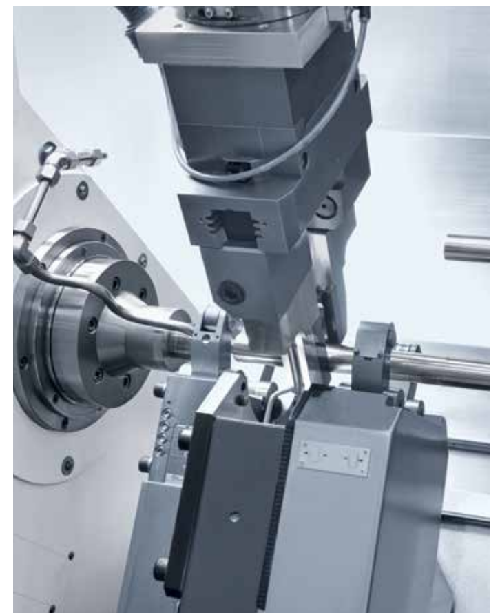
La luneta de la CTX beta 800 linear sirve para estabilizar la pieza durante el fresado de ranuras y de taladros.
