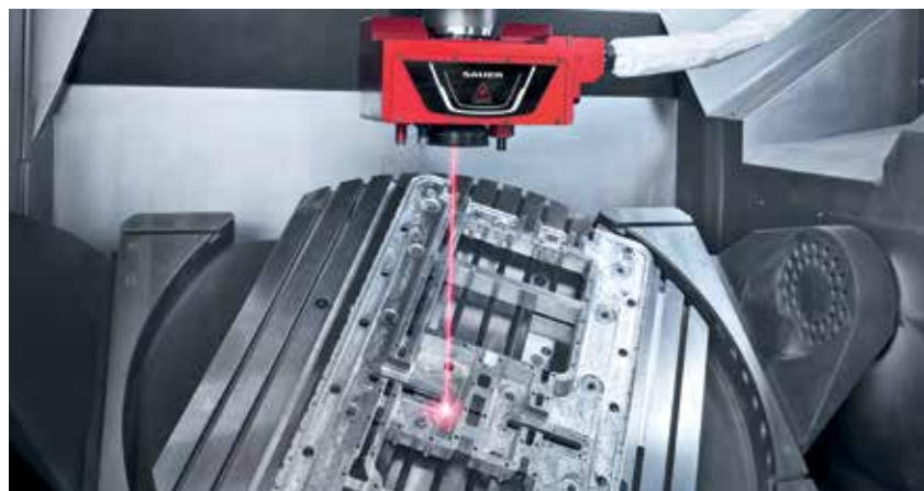
El posible texturizado por láser directo de los moldes en 5 ejes mediante la LASERTEC 125 Shape evita el grabado al agua fuerte que resulta muy complicado y dañino para el medio ambiente.
