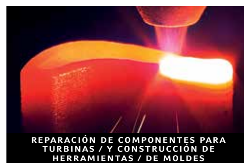
FABRICACIÓN DE PIEZAS 3D COMPLETAS SOLDADURA DE RECARGUE POR LÁSER + MECANIZADO DE FRESADO EN UNA MÁQUINA
