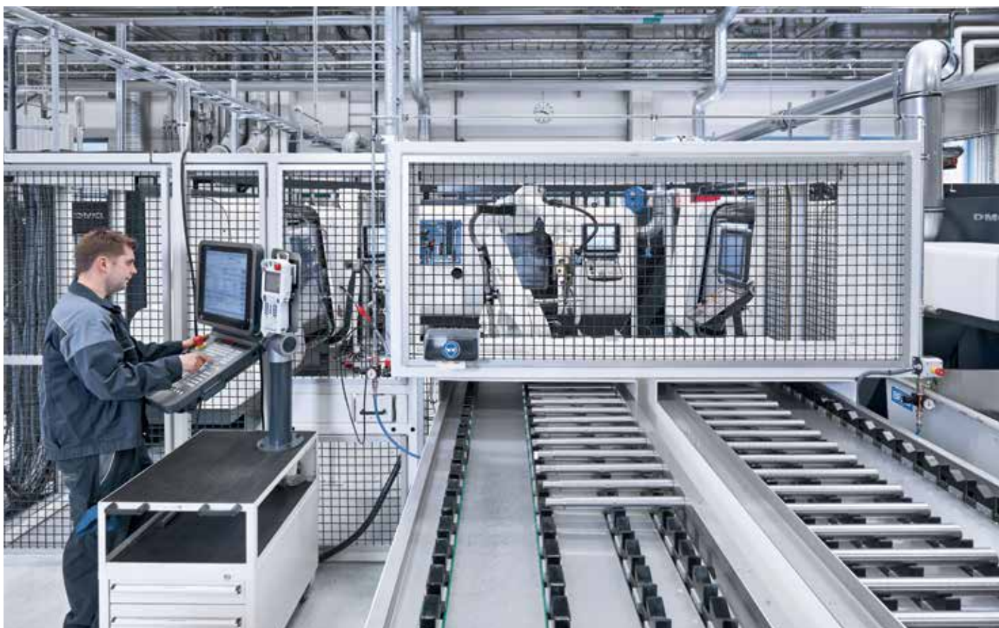
Dos cintas transportadoras se encargan de la carga y descarga de la célula de fabricación. Los demás procesos están completamente automatizados.
