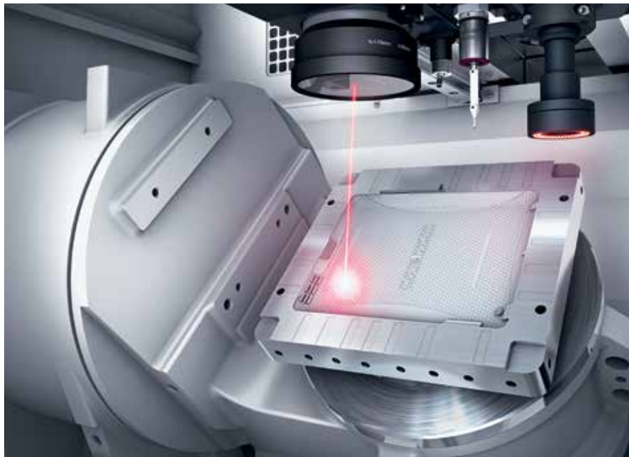
Área de mecanizado de la LASERTEC 45 con mesa rotativa/basculante integrada (versión 5 ejes), cabezal de corte láser con escáner de precisión, cámara CCD y sensor de medición telescópico.
