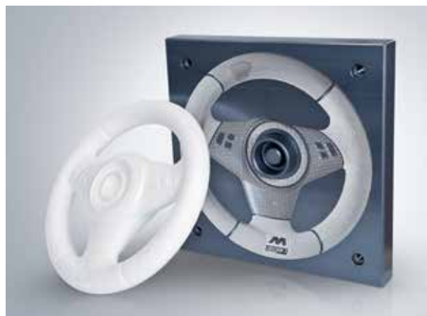
Molde de inyección de espuma para volantes hecho de aluminio y muestra espumada con las más diversas estructuras superficiales (p. ej. textura alveolar, de rejilla reticulada, de cuadrados).
